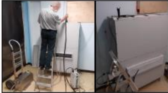
Fig.3 – Testes no protótipo construído e instalado. (a) penetração de partículas nos filtros HEPA. (b) desempenho térmico.
